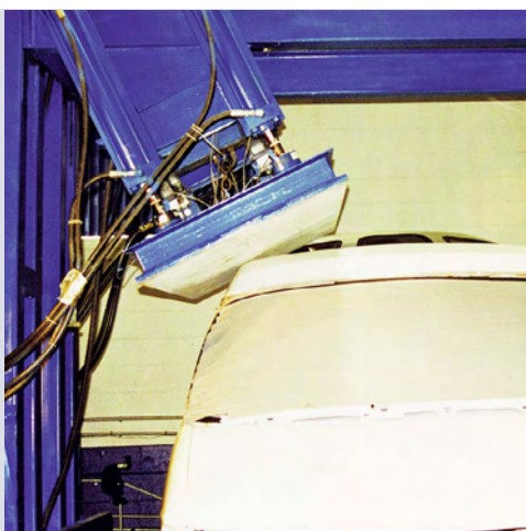
L'essai de résistance à l'écrasement du toit a pour objectif de réduire le nombre de blessures et de morts qui peuvent survenir lorsque le toit s'écrase au cours d'un capotage.
