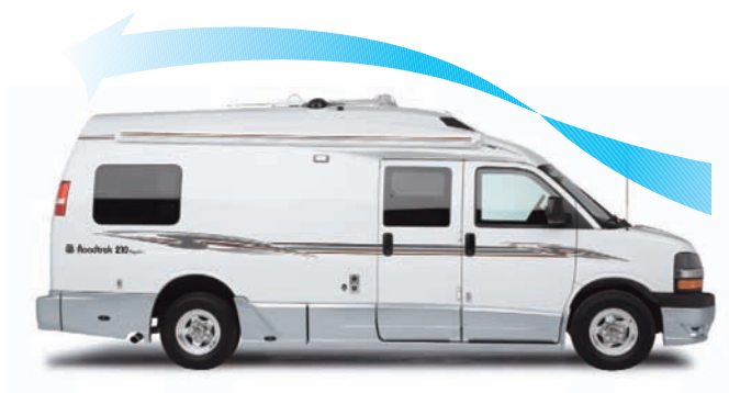
La Roadtrek sur châssis Chevrolet est l'une des fourgonnettes de camping les plus aérodynamiques qui soient. Ses lignes nettes, son profil bas et son faible poids optimisent la maniabilité et la consommation d'essence.
