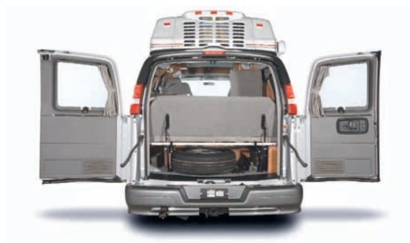
Pour faciliter le chargement, deux portes arrière pivotent sur 180 degrés sur les modèles 170 et 190, et sur 270 degrés sur les modèles RS et SS.
