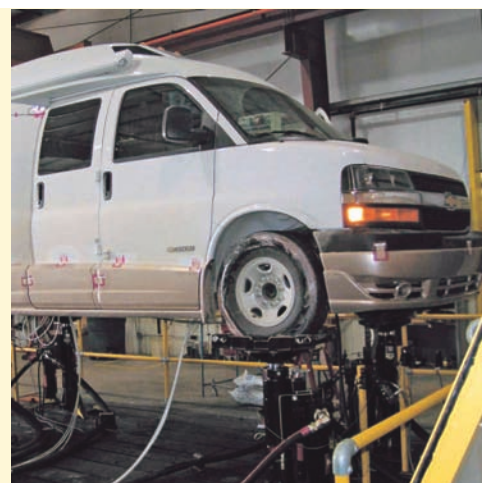
Les essais de durabilité comme ceux que font les fabricants automobiles permettent de déceler de manière anticipée des améliorations potentielles, dont la nécessité n'aurait autrement apparu que pendant la durée de vie normale des premiers de chacun des nouveaux modèles Roadtrek mis en circulation.
