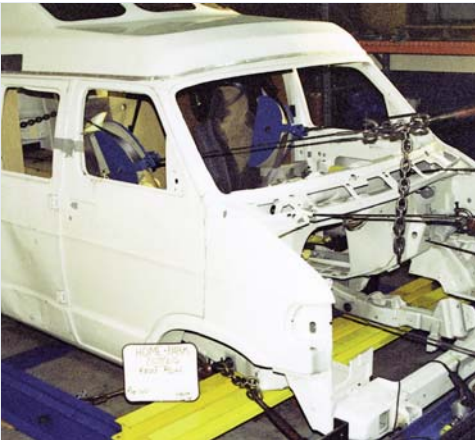
Les deux photographies ci-dessus montrent les essais de résistance à l'arrachement des ceintures de sécurité et des sièges. Les essais sur les ceintures de sécurité confirment la position correcte de la ceinture et la solidité de l'ancrage, tandis que les essais sur les sièges contrôlent l'intégrité des sièges, de leurs fixations, de leurs pièces de montage et de leur installation.
