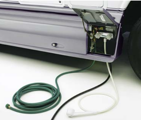
Un compartiment distinct est réservé aux raccords à branchement rapide pour la douche extérieure et l'alimentation en eau. Les modèles 210 et SS offrent également un cordon électrique amovible, pratique pour les séjours hors terrain de camping.
