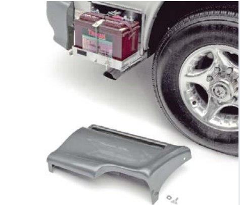
Une batterie d'accumulateurs auxiliaire au plomb de capacité accrue est dissimulée, mais facile d'accès, sur un plateau coulissant. Une seconde batterie auxiliaire est offerte en option pour tous les modèles, sauf le 170.
