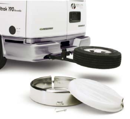
En plus d'avoir fière allure, le porte-roue Continental offert en option réduit l'encombrement à l'intérieur. Il est monté sur l'équipement de remorquage pour éviter les efforts et la rouille sur la porte. Il est aussi déporté par rapport au dispositif d'attelage pour ne pas nuire au remorquage, ni gêner l'accès à une porte arrière. Il suffit de retirer l'axe d'articulation pour descendre la roue de secours et défaire l'attache du couvercle.
