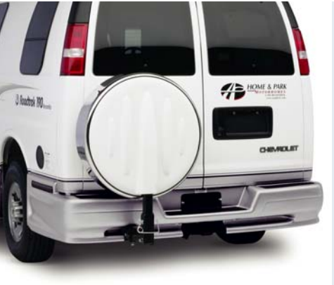
En plus d'avoir fière allure, le porte-roue Continental offert en option réduit l'encombrement à l'intérieur. Il est monté sur l'équipement de remorquage pour éviter les efforts et la rouille sur la porte. Il est aussi déporté par rapport au dispositif d'attelage pour ne pas nuire au remorquage, ni gêner l'accès à une porte arrière. Il suffit de retirer l'axe d'articulation pour descendre la roue de secours et défaire l'attache du couvercle.
