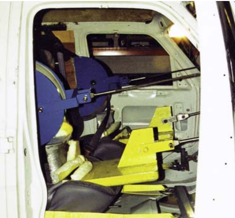
Les deux photographies ci-dessus montrent les essais de résistance à l'arrachement des ceintures de sécurité et des sièges. Les essais sur les ceintures de sécurité confirment la position correcte de la ceinture et la solidité de l'ancrage, tandis que les essais sur les sièges contrôlent l'intégrité des sièges, de leurs fixations, de leurs pièces de montage et de leur installation.
