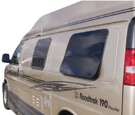
Non seulement plus belles, les fenêtres latérales sans cadre de style auvent réduisent le bruit du vent, améliorent l'aérodynamique et procurent une excellente circulation d'air, même par mauvais temps. Plus grandes, elles offrent une meilleure vue de l'intérieur. Le système de ventilation intégré (modèles 170 et 190) apporte une ventilation non apparente au réfrigérateur.
