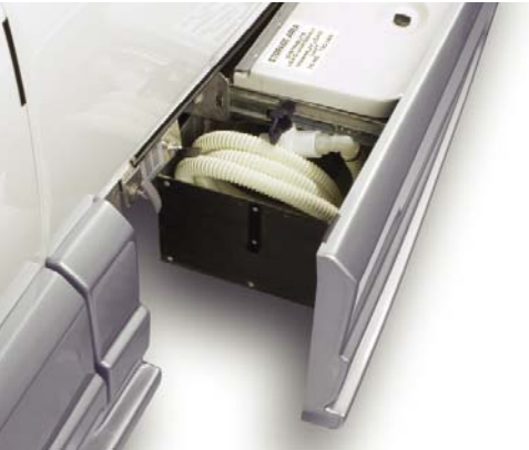
La pompe déchiqueteuse broie les matières contenues dans le réservoir d'eaux noires et les évacue par un boyau pratique de 1¼ pouce (3,2 cm). Pas de troubles! Pas de dégâts!
