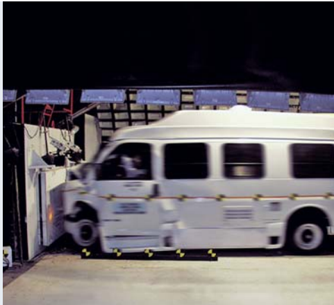
La photo ci-dessus illustre un essai de collision arrière. Le véhicule est percuté par une barrière mue à une vitesse de 48 km/h (30 mi/h). Une vérification complète du système d'alimentation en carburant après coup n'a révélé aucune fuite.
