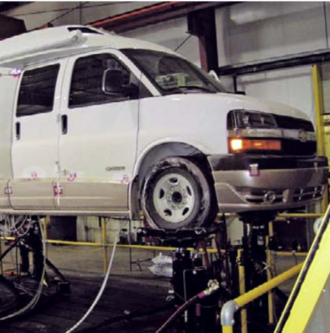
Les essais de durabilité comme ceux que font les fabricants automobiles permettent de détecter de manière anticipée des améliorations potentielles, dont la nécessité serait autrement apparue que pendant la durée de vie normale des toutes premières Roadtrek mises en circulation.
