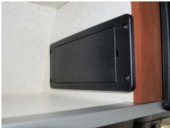
12 volt DC fuse box
