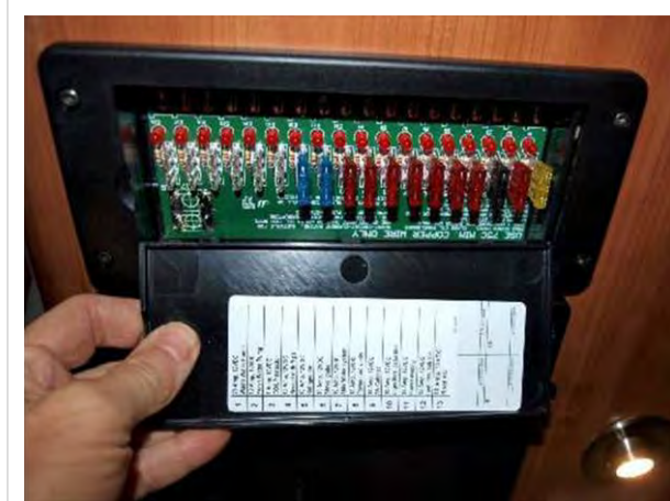
12 volt DC fuse box
