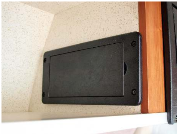
12 volt DC fuse box
