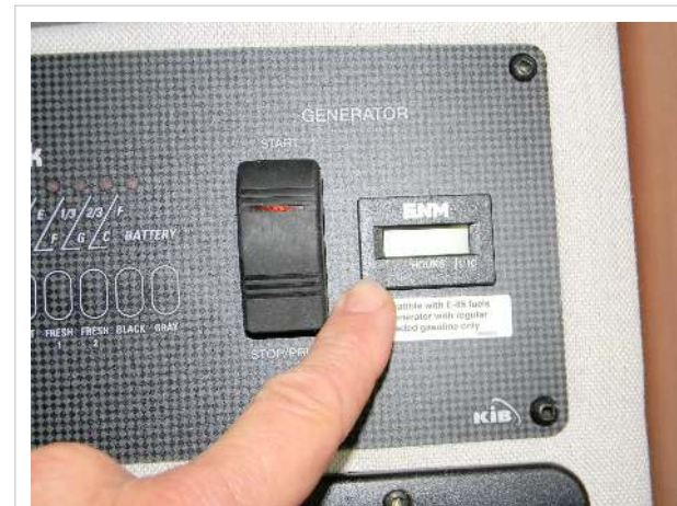
Generator hour meter
