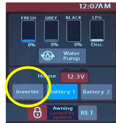
Interrupteur de l'onduleur 46.2
