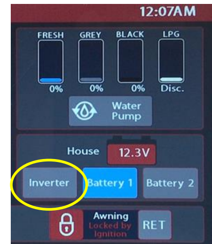
Interrupteur de l'onduleur
