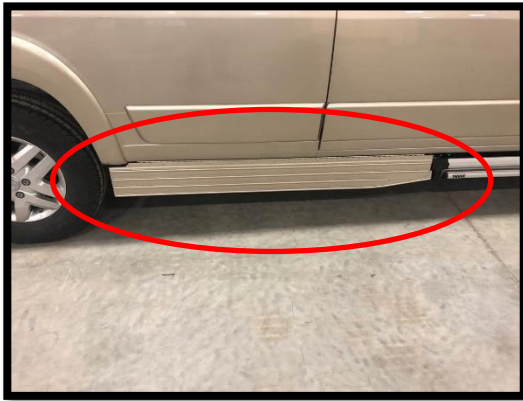
36.4 Emplacement du réservoir de propane
