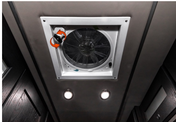
Figure 30.2 Ouvrez et fermez le couvercle du ventilateur à l'aide de la molette.
