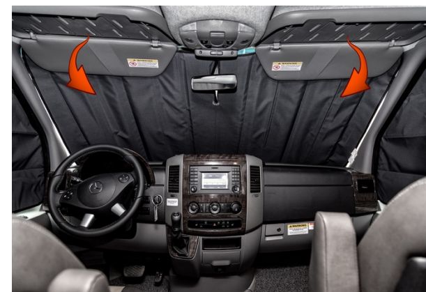
Figure 29.6 Pare-soleil en place dans le pare-brise. *Remarque : ouvrez les pare-soleil amovibles pour maintenir la portion supérieure en place.
