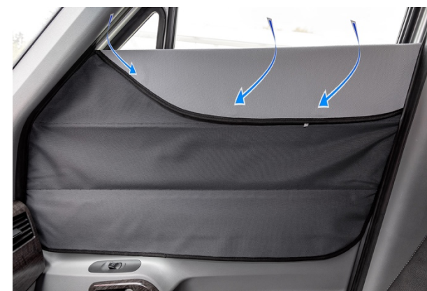
Figure 29.3 Une fois la portière ouverte, fixez le pare-soleil en place à l'aide des aimants intégrés.
