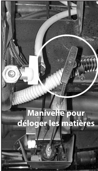
Photo G-P15: Pompe déchiqueteuse située sous le centre du véhicule Manivelle de la pompe déchiqueteuse
