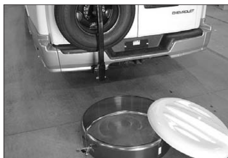
Photo B-P46: Anneau de chrome et disque en fibre de verre retirés.
