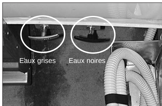
Photo B-P35: Emplacement des robinets-vannes des eaux noires, des eaux grises et du boyau d'évacuation
