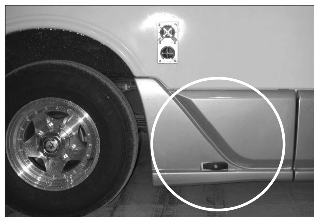
Photo B-P42: Compartiment de batterie auxiliaire.
