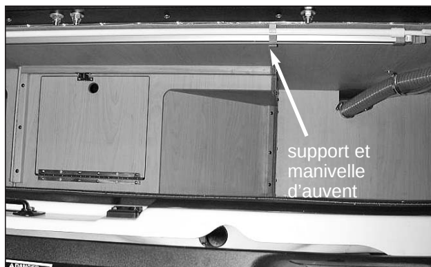
Photo B-P40A: Rangement du support et de la manivelle d'auvent.
