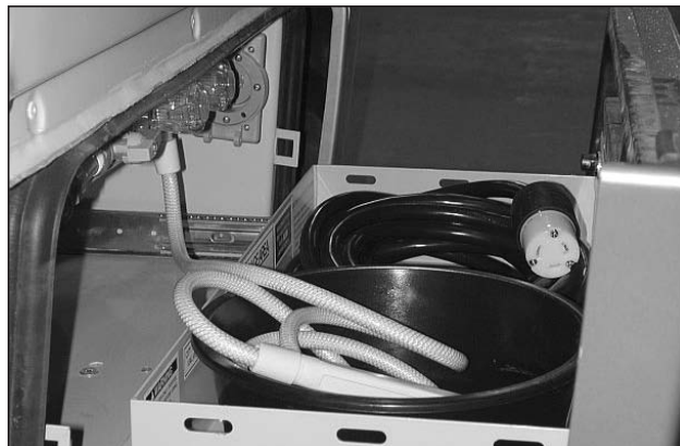
Photo G-P19: Douche extérieure, boyau de douche et cordon d'alimentation électrique en position de rangement quand la caravane motorisée est garée.
