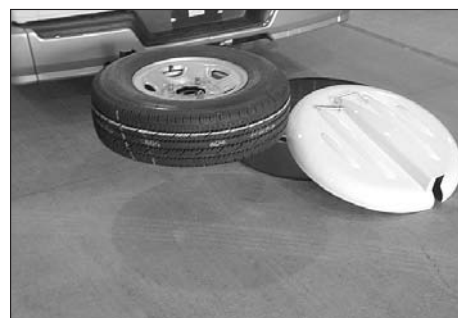
Photo B-P47: Goupille de coude ôtée et dispositif d'attelage descendu pour retirer la roue
