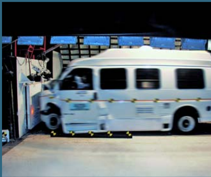
Essai de collision frontale. Le véhicule percute une barrière fixe à une vitesse de 48 km/h (30 mi/h). Aucune fuite de carburant n'a été décelée sur le véhicule.
