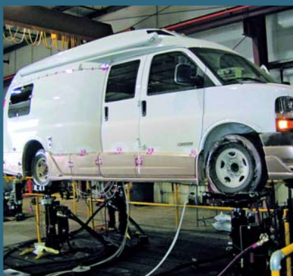
Les essais de durabilité comme ceux que font les fabricants automobiles permettent de détecter de manière anticipée des améliorations potentielles, dont la nécessité n'aurait autrement apparu que pendant la durée de vie normale des toutes premières Roadtrek mises en circulation.
