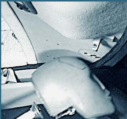
Les essais qui visent la protection de la tête des occupants confirment que les occupants bénéficient de la protection additionnelle que procurent certaines pièces intérieures au cours d'une collision.
