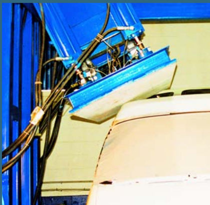
Les essais de résistance à l'écrasement du toit visent à réduire le nombre de morts et de blessures qui surviennent à la suite de l'écrasement du toit au cours d'un capotage.
